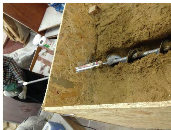
Рис. 2. Вращение шнека при помощи перфоратора
