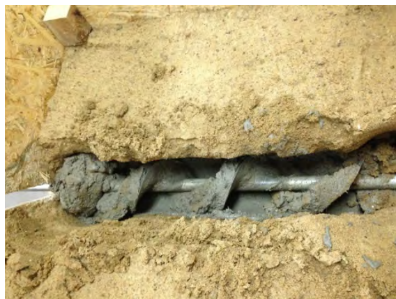
Рис. 7. Процесс перемешивания раствора и готовый очищенный участок экрана
