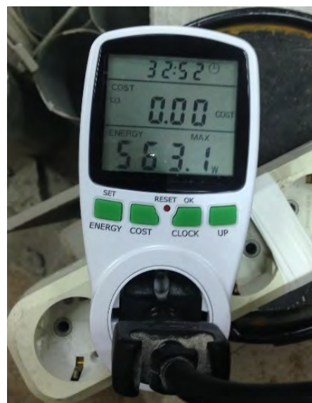
Рис. 3. Измерение мощности при различной частоте вращения шнека
